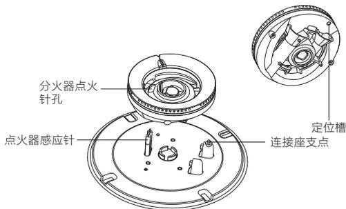
**步骤一：**将分火器点火针孔穿过点火感应针，同时，分火器的定位槽置于连接座支点上。
