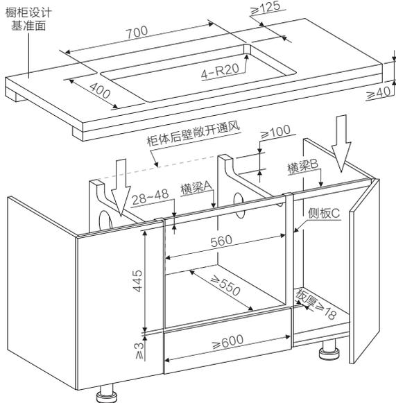
注：横梁A、横梁B、侧板C三者需在同一水平面上。
