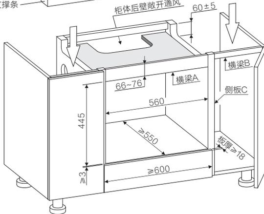
注: 横梁A、横梁B、侧板C三者需在同一水平面上。
