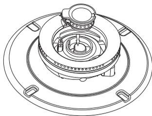
**步骤三：**将内火盖对准放置在分火器上，直至紧密贴合。
