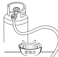
管道气密性检测
